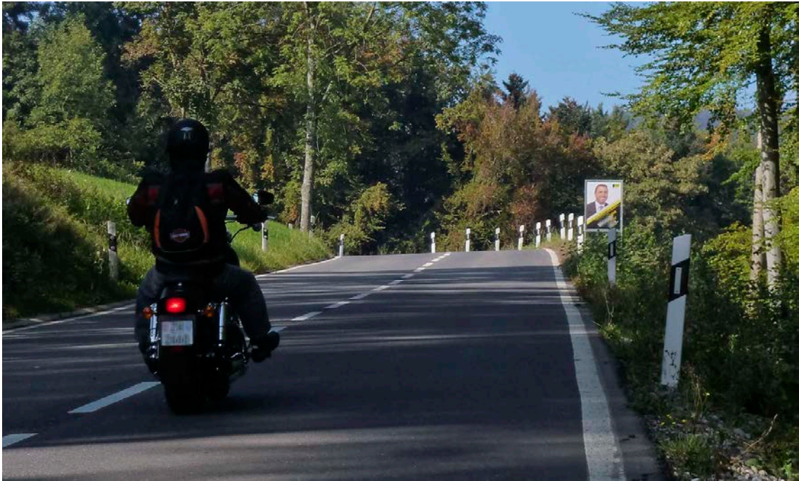
Abb. 89: Wahlplakat in massivem Stahlrahmen in potentiellm Sturzraum
