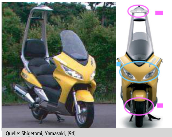
Abbildung 14 Lichttechnische Massnahmen zur Verbesserung der Sichtbarkeit
